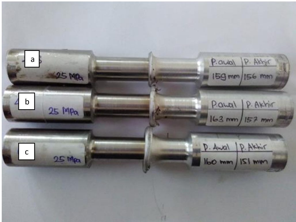
Gambar 4.2 Hasil sambungan pengelasan gesek waktu gesek (a) 2 detik (b) 4 detik (c) 6 detik.
