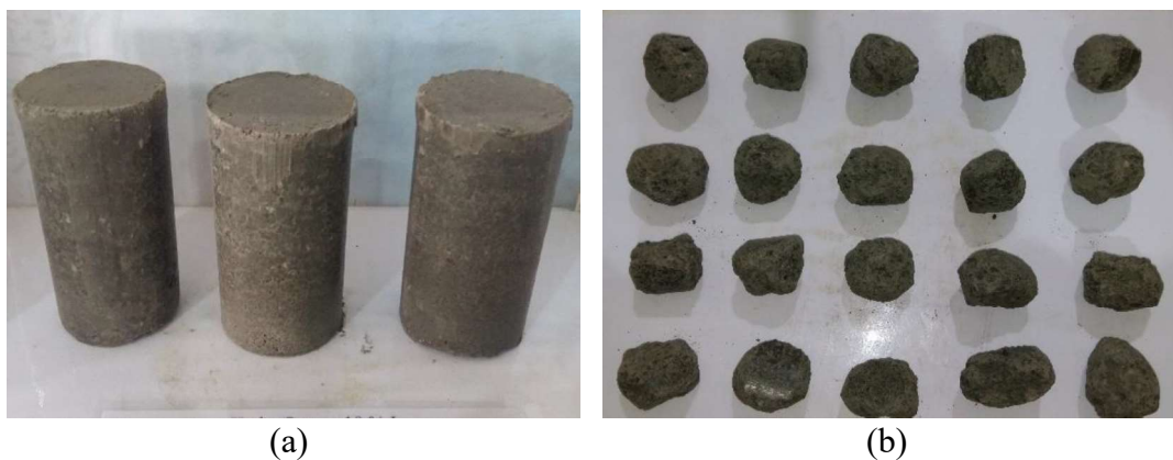
Gambar 3.13 Spesimen B (a) Setelah Dicetak, (b) Setelah Dipecah
