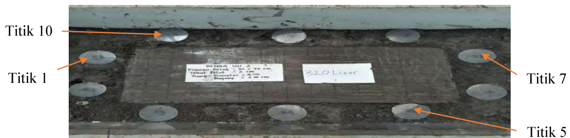
Gambar 4. 6 Ilustrasi titik pengujian pengembangan tanah
