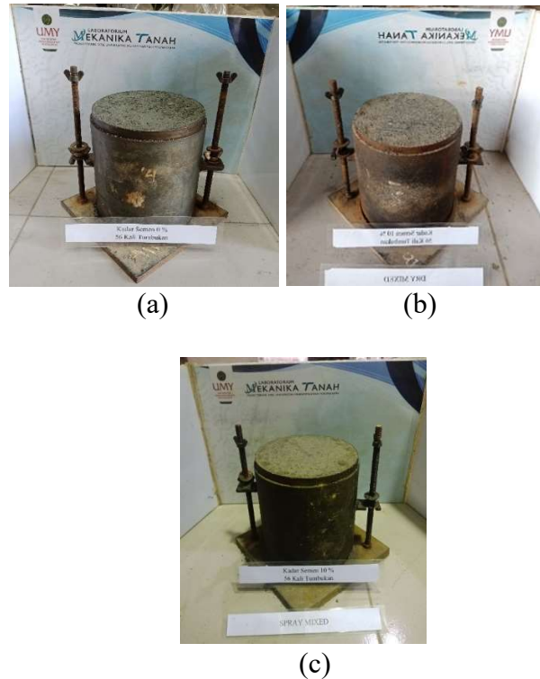
Gambar 2 Benda Uji yang telah dicetak (a) kadar semen 0%, (b) kadar semen 10% dry mix, (c) kadar semen 10% spray mix
