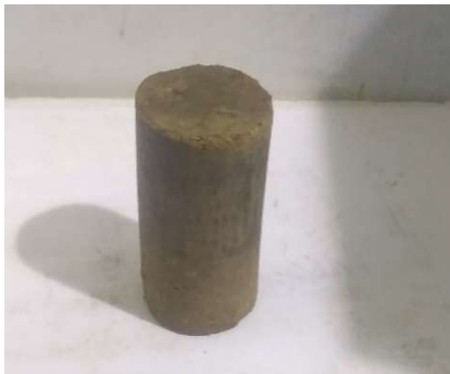
Gambar 27 Siltstone Spray Mix 10% I Sebelum Pengujian
