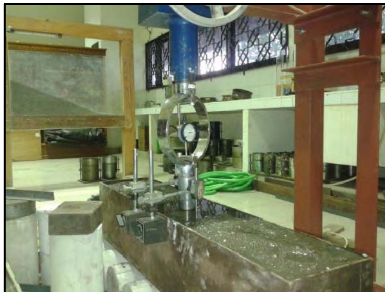
Gambar 4.13 Kotak model berisi tanah yang telah dipadatkan.
