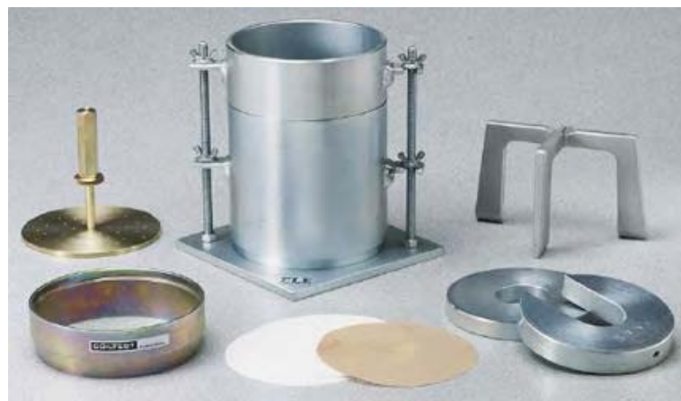
Gambar 4.7 Mesin uji penetrasi dan Silinder pemadatan CBR beserta kelengkapan
