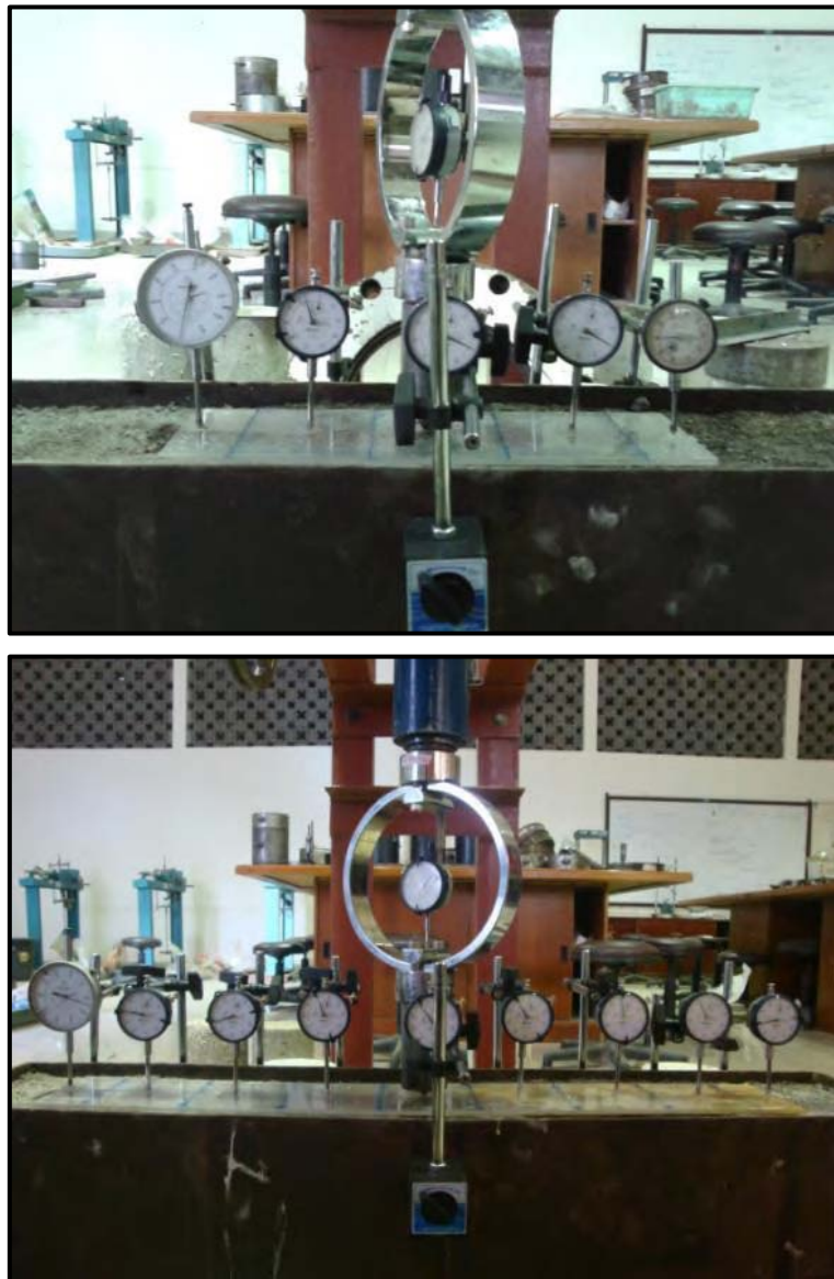
Gambar 4.17 Pengaturan arloji penolak ukur deformasi dan proving ring .
