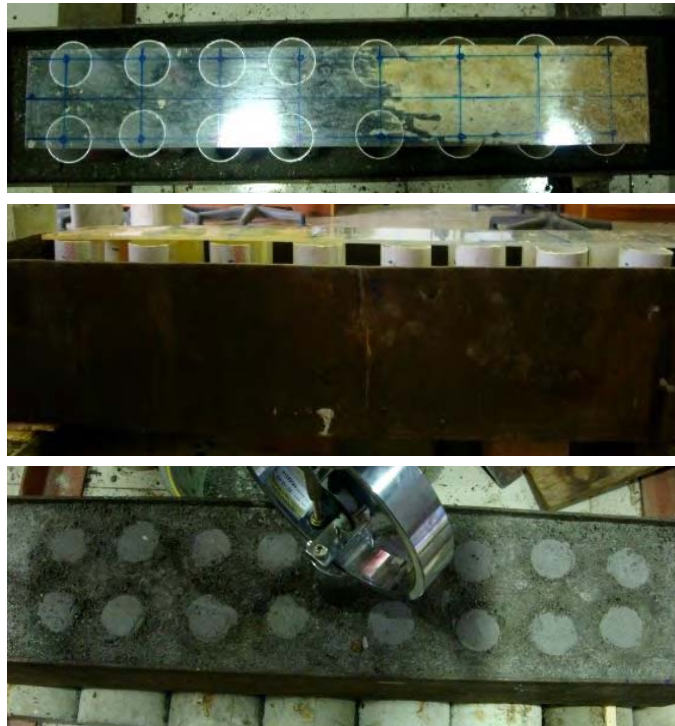
Gambar 4.14 Pembuatan kolom-kolom pada tanah yang dipadatkan pada kotak model
