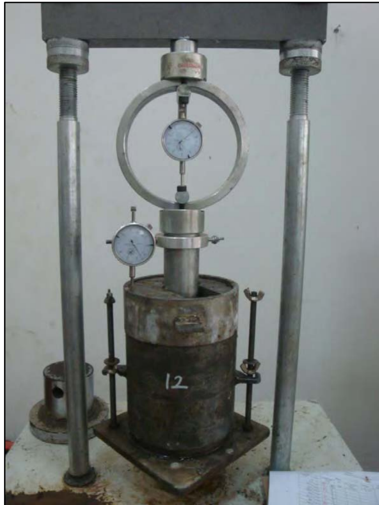
Gambar 4. 12 Uji penetrasi CBR setelah uji rendaman
