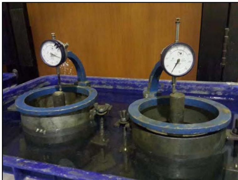
Gambar 4.11 Benda uji yang direndam sebelum uji penetrasi CBR.
