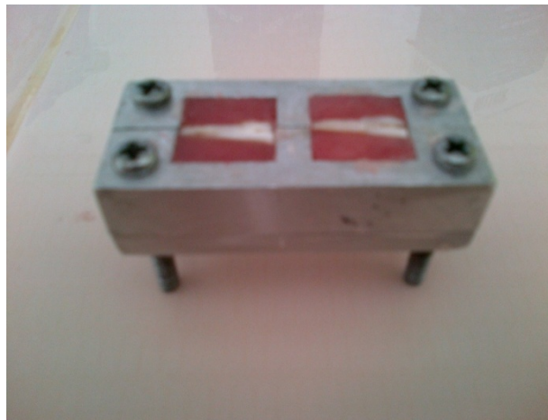
Gambar 12. Sampel dentin gigi yang telah ditanam dalam cetakan baja dengan resin akrilik.
