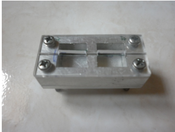
Gambar 10. Cetakan baja berbentuk balok untuk membuat sampel
