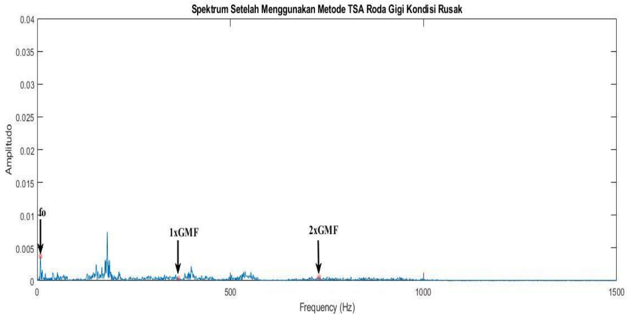
Gambar 20. Plot spektrum frekuensi 5 kali putaran poros setelah TSA pada roda gigi kondisi rusak
