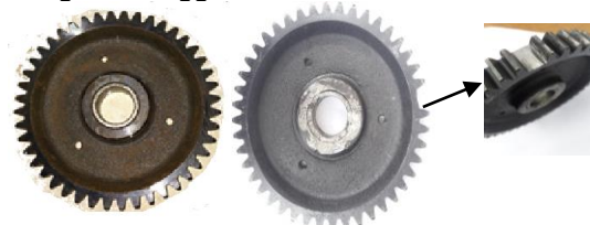
Gambar 3. Roda gigi lurus kondisi normal dan rusak patah satu gigi
