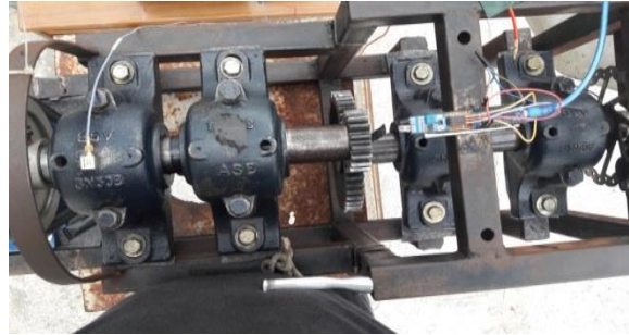
Gambar 3.6 Posisi roda gigi yang akan dirusak
