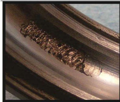
Gambar 2.14 Kerusakan Lokal pada Lintasan Luar ( http://jadanalysis.co.uk;http://www.nskamericas.com/cps/rde/xchg/na_en/hs.xsl/cage-damage.html; )
