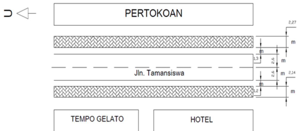
Gambar 4.4 Kondisi geometrik ruas jalan Taman Siswa
