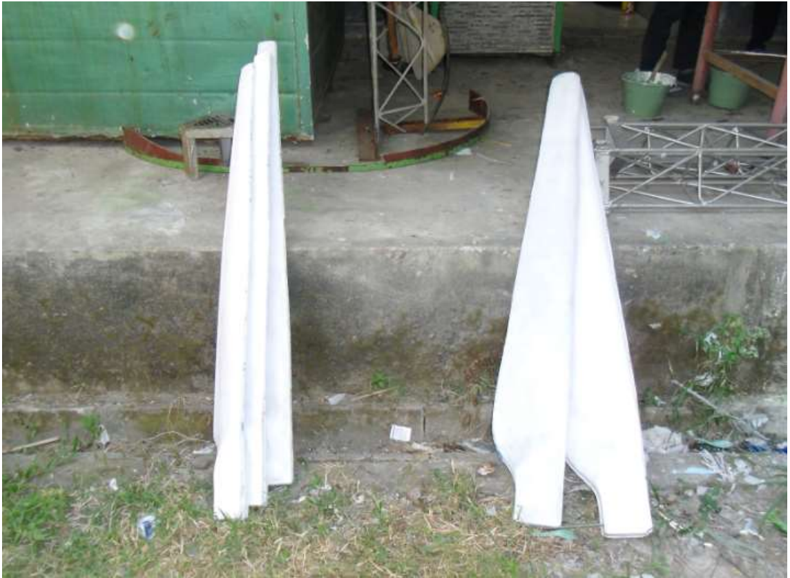
Gambar 5.2. Bilah turbin (blade) hasil cetakan
