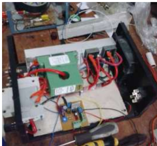
Gambar 5.4. Pembuatan controller untuk wind turbine
