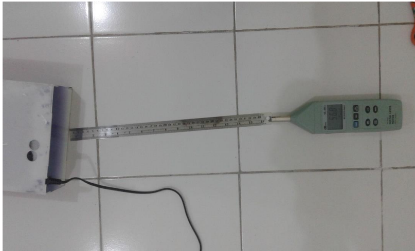
Pengukuran Sisi Bawah Alat 56 dB
