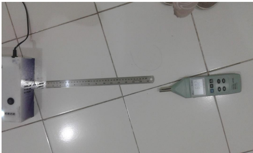
Pengukuran Sisi Kiri Alat 60 dB
