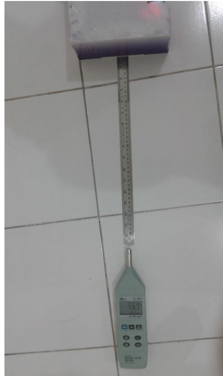
Pengukuran Sisi Kanan Alat 56 dB
