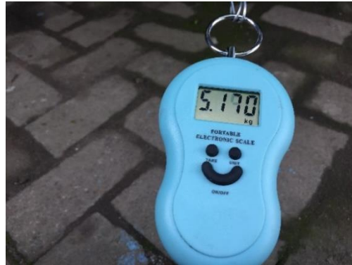
Gambar 4.4 Pengambilan Data Pemberian Beban Pada Pedal
