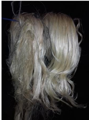
Gambar 3.19 Serat Rami Setelah Kering
