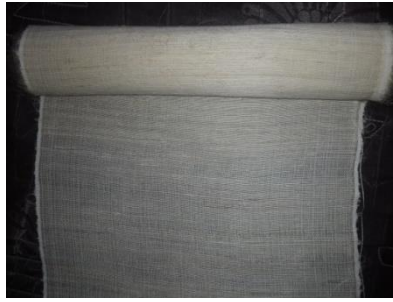
Gambar 3.21 Hasil Serat Rami Setelah Ditenun
