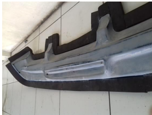
Gambar 3.26 Master Diberikan Spon Dibagian Ujung Master
