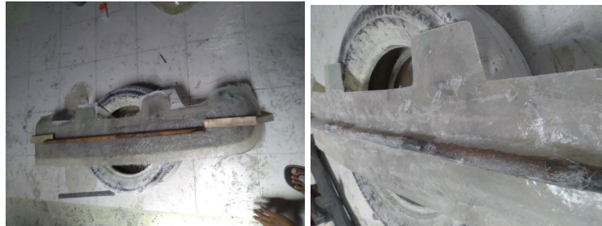
Gambar 3.30 Cetakan Diberikan Penyangga Agar Hasil Tidak Terjadi Deformasi
