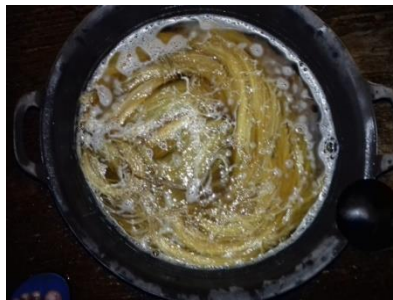
Gambar 3.18 Serat Rami Direndam Pada Larutan NaOH
