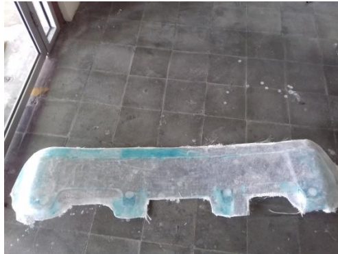
Gambar 3.29 Hasil Cetakan Setelah Dicotot Dari Master
