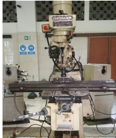
Gambar 3.2. Mesin Milling Vertikal
