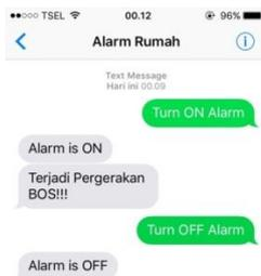
**Gambar 4.23** Hasil *Screenshot* pengujian *SIM800L* sebagai sistem kontrol notifikasi
