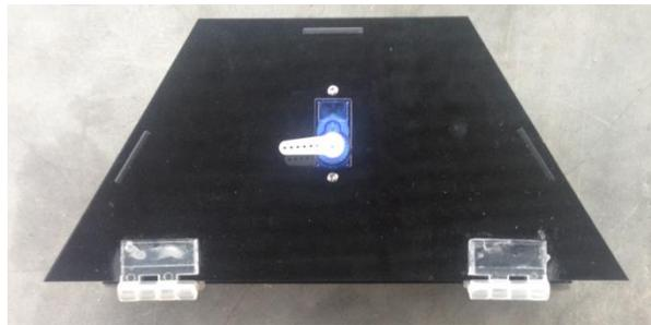
Gambar 4.3 Sudut 0° *Motor Servo*
