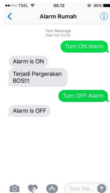
Gambar 4.30 Hasil *Screenshot* pengujian *SIM800L* sebagai sistem kontrol notifikasi
