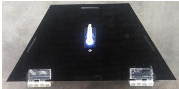
Gambar 4.4 Sudut 90° *Motor Servo*
