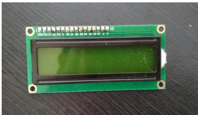
**Gambar 2.9.** LCD 16x2
