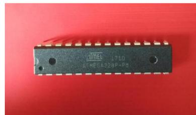
**Gambar 2.1** Mikrokontroler ATmega 328
