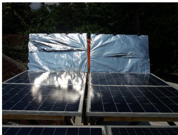
Gambar 4.5 Panel Surya dengan Reflektor aluminium foil
