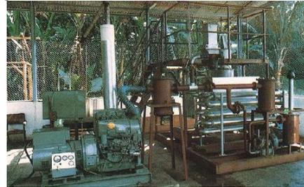
Gambar 2.1 Unit Gasifikasi di ITB
