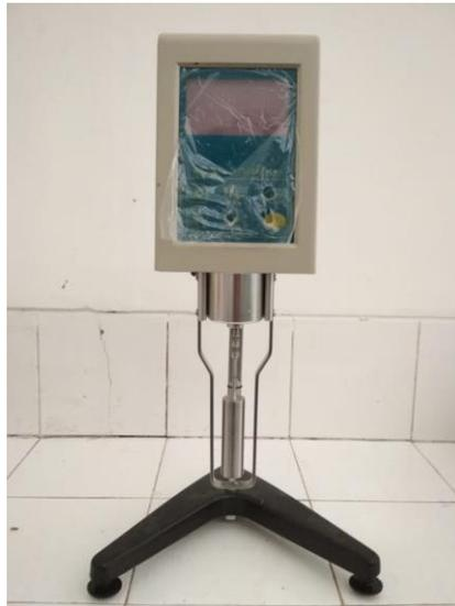
Gambar 3.10 Alat Uji Viskositas (*Viskometer*)
