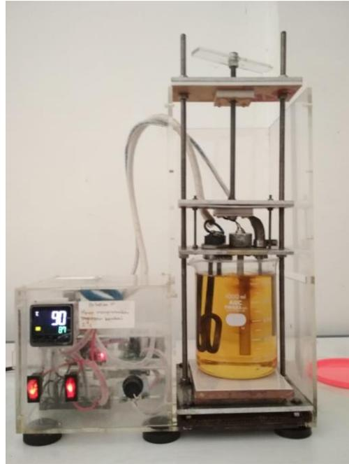
Gambar 3.6 Alat Pencampur dan Pembuat Biodiesel
