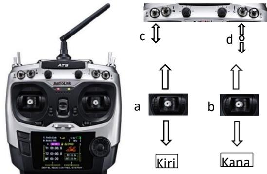
Kontrol gerakan dilakukan menggunakan remote AT9 dengan bentuk kontrol joystick dan Switch. Gerakan alat maju, mundur, belok kanan dan belok kiri dengan cara merubah kecepatan putar roda rantai kiri dan kanan. Untuk berbelok kiri maka roda rantai sebelah kiri
