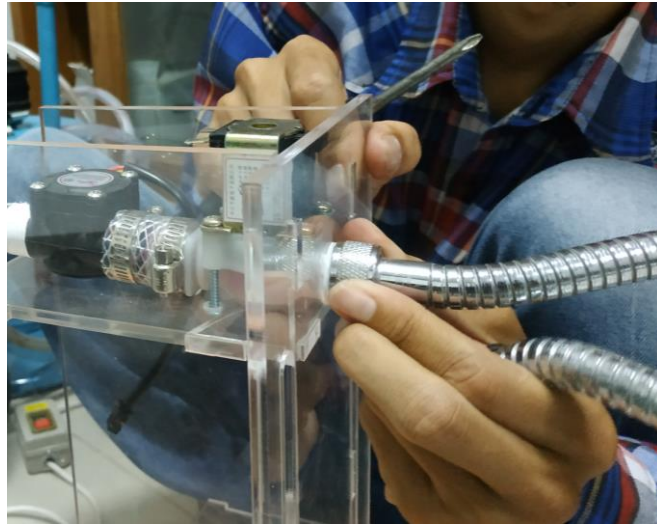
Gambar 4.31. Pemasangan selang pada katup selenoid
