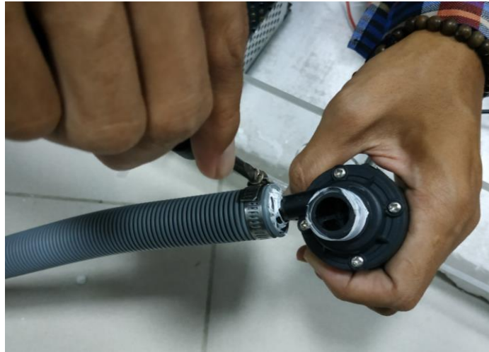
Gambar 4.28. Pemasangan selang pada pompa
