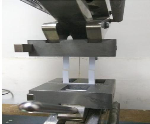
**Gambar 3.16.** Proses uji serat tunggal
