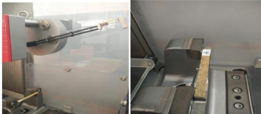
**Gambar 3.23.** Proses pengujian Impak
