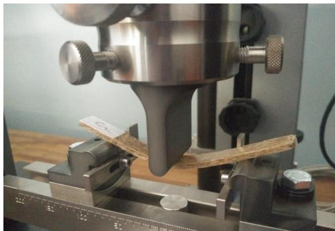
**Gambar 3.25.** Proses pengujian Bending
