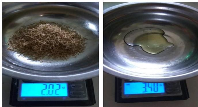
**Gambar 3.18.** Penimbangan Serat dan Resin Epoxy
