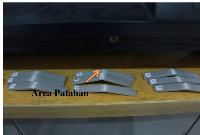
Gambar 4.3. Spesimen hasil uji bending
