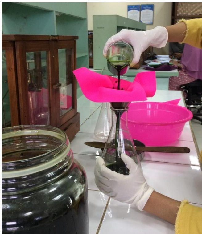
Gambar 16. Proses Penyaringan Tahap I ( Menggunakan Kain Flanel)
