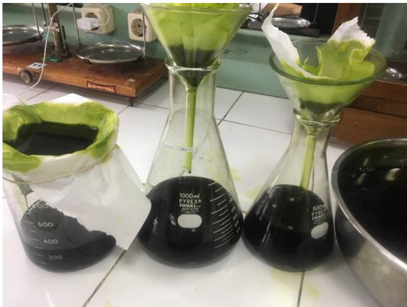
Gambar 17. Proses Penyaringan Tahap II (Menggunakan Kertas Saring)
