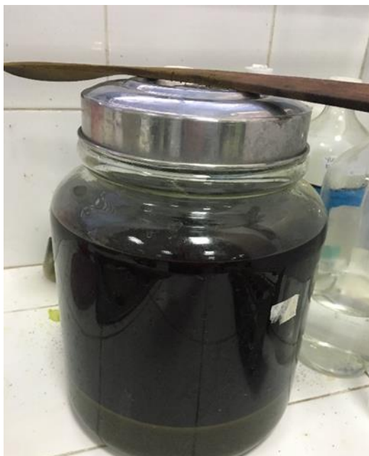
Gambar 14. Serbuk Halus Simplisia Kering Ekstrak Daun Pepaya ( Carica Papaya L. ) di Rendam dengan Etanol 96%
