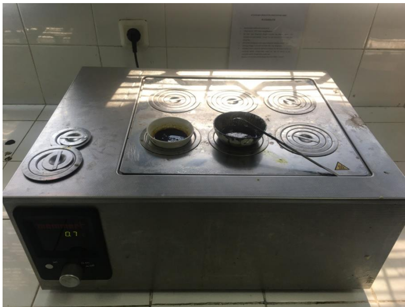
Gambar 19. Penguapan Larutan Menggunakan Waterbath
