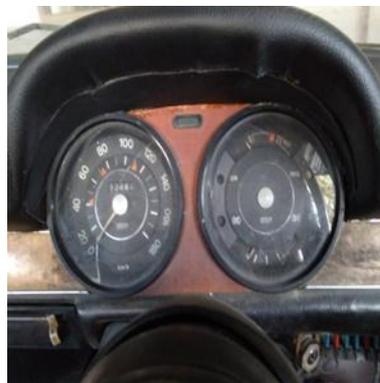
Gambar 2.18 Lampu indikator dan *Gauge* meter FIAT 124 S
