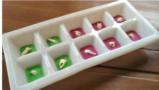
Gigi pada clay sebelum ditanam dalam balok resin
