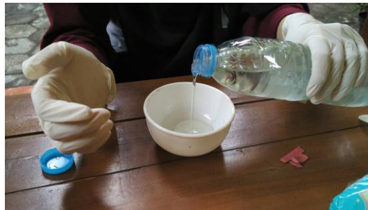
Mencampur resin dengan katalis untuk membuat balok resin
