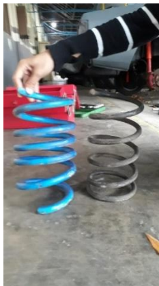
Gambar 4.10 Coil belakang Toyota Avanza (kiri) dan Mitsubishi Lancer SL (kanan)
