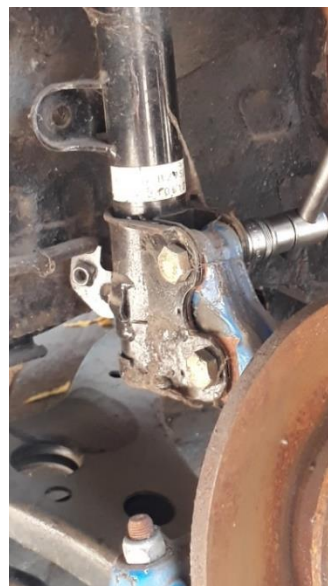
Gambar 4.13 Dudukan Shock Mitsubishi Lancer SL Gambar 4.14 Dudukan Shock Avanza
