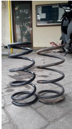
Gambar 4.8 Coil depan Toyota Avanza (kiri) dan Mitsubishi Lancer SL (kanan)
