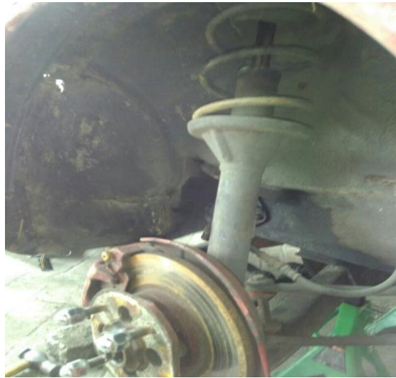
Gambar 4.2 Shock depan Lancer SL bagian kiri
