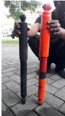
Gambar 4.9 Absorber belakang Mitsubishi Lancer SL (kiri) dan Toyota Avanza (kanan)
