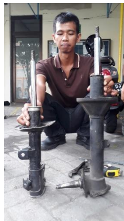
Gambar 4.7 Shock Toyota Avanza (kiri) dan Mitsubishi Lancer SL (kanan)
