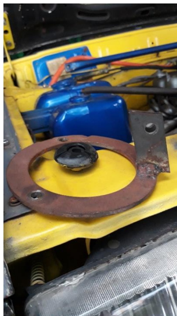
Gambar 4.12 Development dudukan Strut Bar
