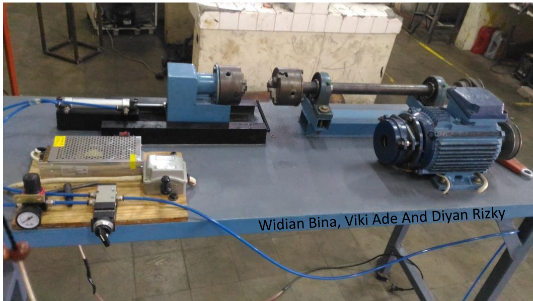
Gambar 1.1 Alat Las Gesek (Friction Welding) Kapaitas 5,5 Kgf/Cm 2
