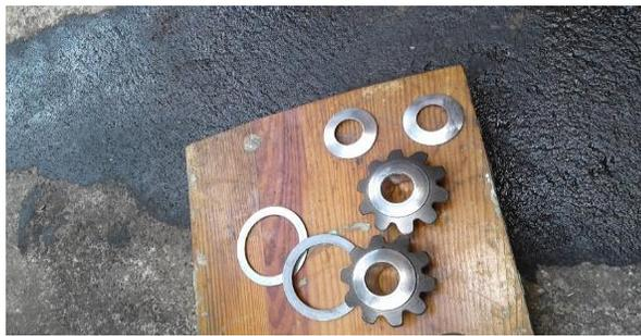
Gambar 2.17 *Pinion gear* dan *ring*
