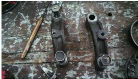
Gambar 2.7. Tutup bantalan (*Bearing cap*)
