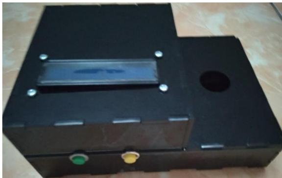
Gambar 4. 1 *Prototype* Pendeteksi Tingkat Dehidrasi Melalui Urine Manusia
