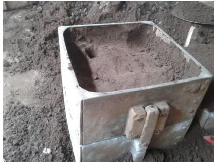
Gambar 4.2 Cetakan yang sudah disatukan
