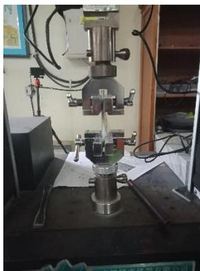
Gambar 3.7 Mesin Uji Tarik UTM
