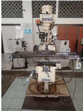
*Gambar 3.2* Mesin Milling Vertikal
