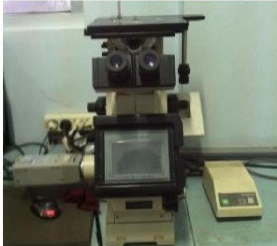
Gambar 3.5 Mesin Uji Struktur Mikro
