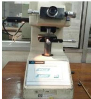
Gambar 3.6 Mesin Uji Kekerasan Vickers
