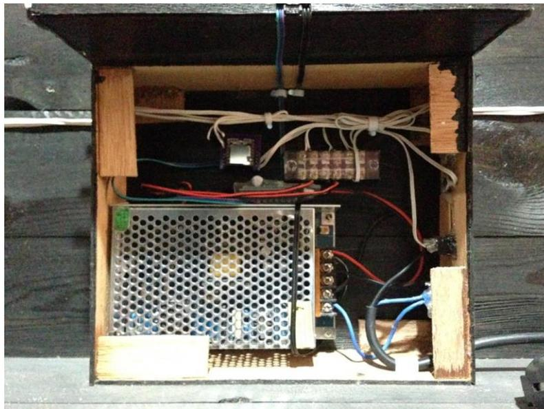
**Gambar 4.1** Tempat Komponen *Power Supply*, SBEC, Modul Mp3
