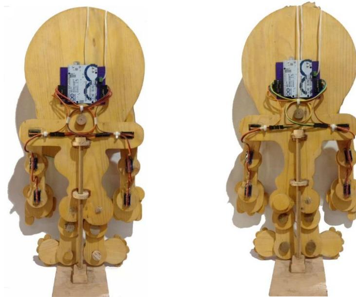
**Gambar 4.2** Letak Arduino dan Motor Servo
