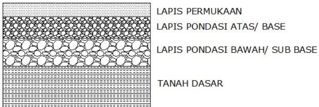
Gambar 2.4. Susunan lapis pada perkerasan lentur
