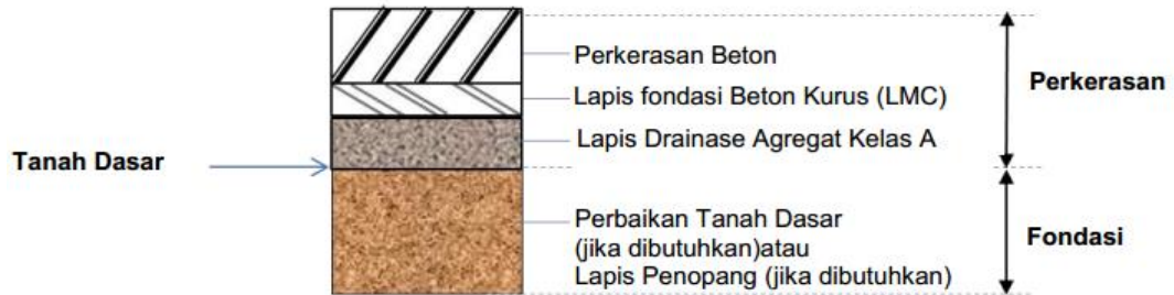
Gambar 2.5. Perkerasan kaku pada tanah asli (Bina Marga, 2017)
