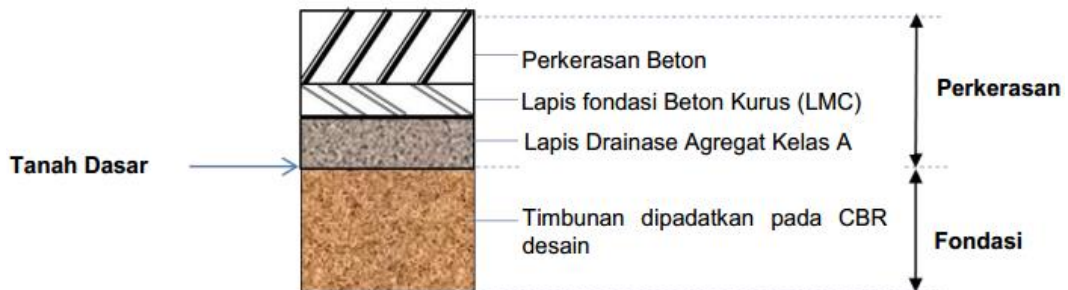
Gambar 2.6. Perkerasan kaku pada tanah timbunan (Bina Marga, 2017)
