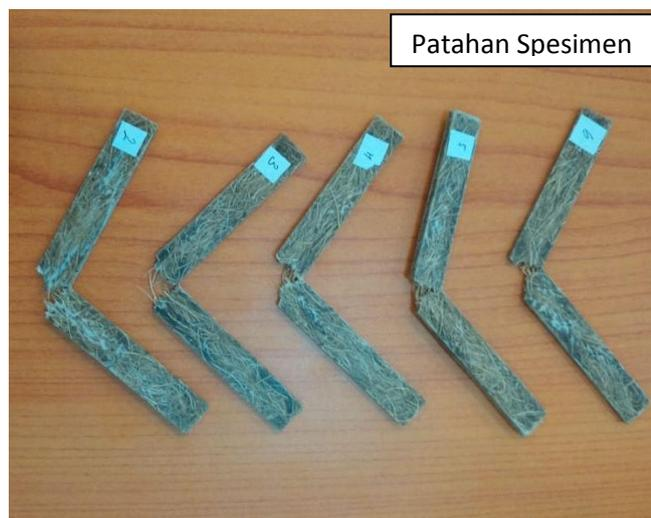
Gambar 4.9 Patahan spesimen uji impact
