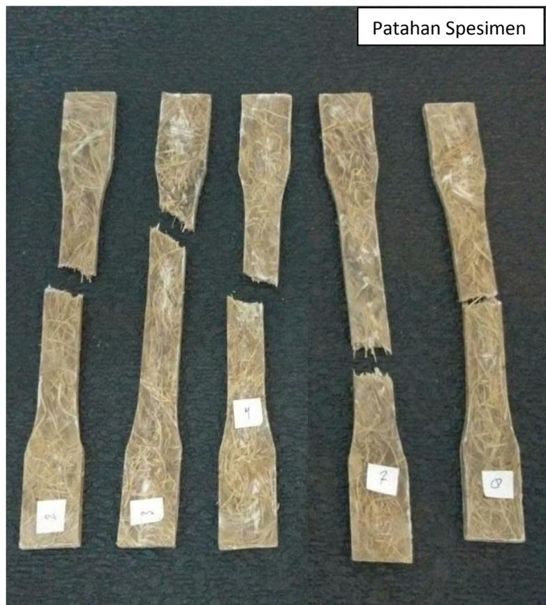
Gambar 4.8 Patahan spesimen uji tarik
