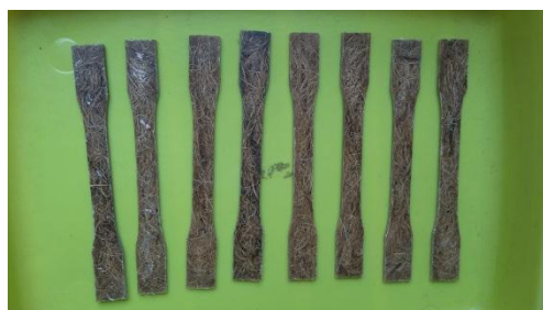
Gambar 3283 Spesimen uji tarik standar ASTM D638
