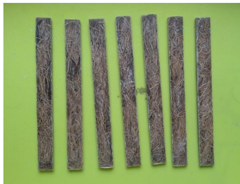
Gambar 3.27 Spesimen uji impak standar ASTM D6110
