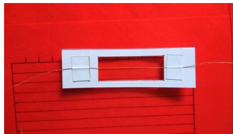
Gambar 3.16 Spesimen uji serat tunggal TKKS
