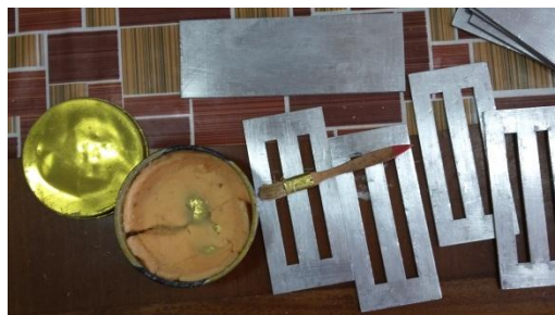
Gambra 3.23 Melumuri permukaan cetakan dengan release agent
