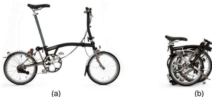
Gambar 2.5 Sepeda Brompton dalam posisi terbuka (a) dan posisi tertutup (b)
