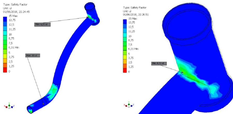
Gambar 4.33 Hasil analisis safety factor pada frame depan
