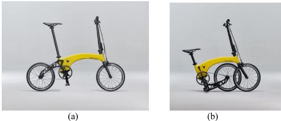
Gambar 2.4 Sepeda lipat Hummingbird dalam posisi terbuka (a) dan posisi terlipat (b) (Sumber: https://hummingbirdbike.com )
