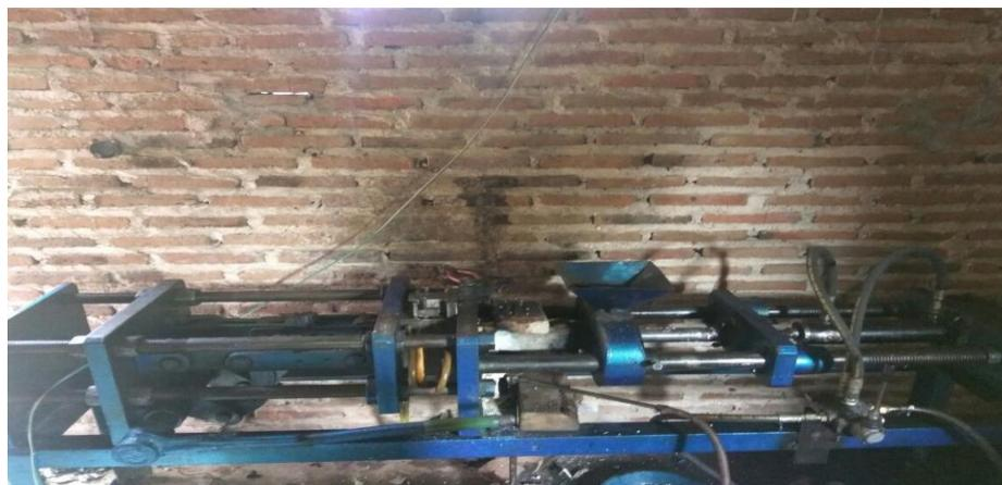
Gambar 3.7 Mesin injeksi manual
