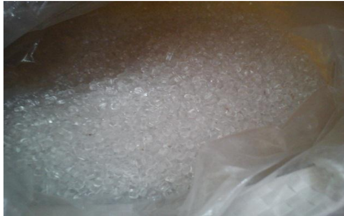
Gambar 3. 5 Bahan Polycarbonate wonderlite 110 murni.
