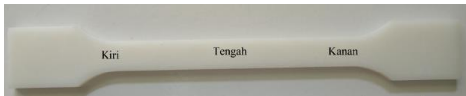
Gambar 3. 9 Pengukuran ketebalan dan kelebaran spesimen
