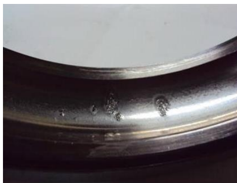
Gambar 2. 10 Kerusakan Lokal pada Lintasan Dalam https://m0103.files.wordpress.com/2014/08/images6.jpg
