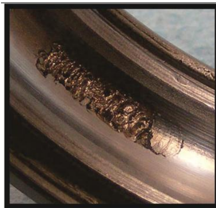
Gambar 2.10 cacat local pada lintasan luar (Sumber : Analysis, 2018)
