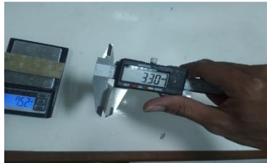
Gambar 3.30 Pengukuran Tebal dan Penimbangan Berat Spesimen sebelum Perendaman
