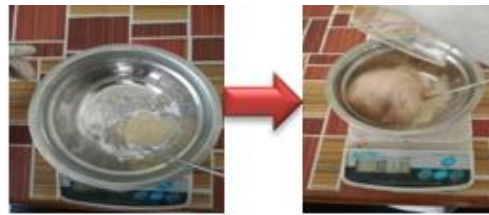
Gambar 3.23 Pencampuran Epoksi, Silica Fume dan Serat Kenaf
