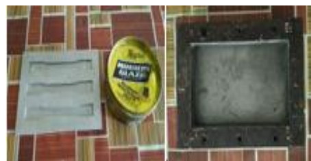
Gambar 3.24 Pengolesan Cetakan dengan Wax Mold Release
