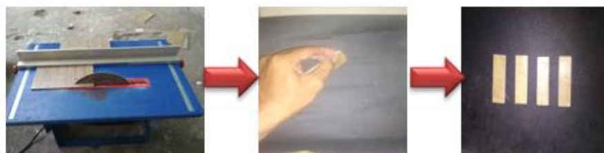
Gambar 3.29 Pemotongan dan Pengamplasan Spesimen Uji Daya Serap Air
