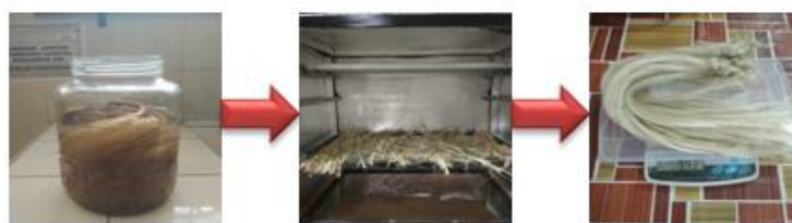
Gambar 3.19 Pencucian Serat menggunakan Aquades, Pengeringan Serat, dan Penimbangan Serat
