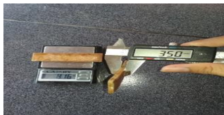
Gambar 3.32 Pengukuran Tebal dan Penimbangan Berat Spesimen setelah Perendaman
