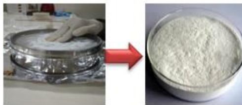
Gambar 3.21 Pengayakan Silica Fume
