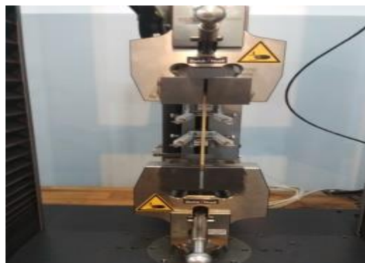
Gambar 3.27 Spesimen yang sudah dipasang pada Mesin Uji Tarik
