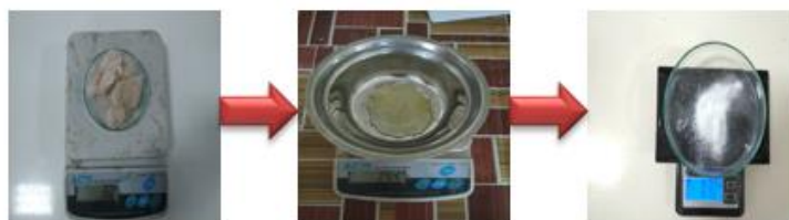
Gambar 3.22 Penimbangan Serat Kenaf, Epoksi, dan Silica Fume
