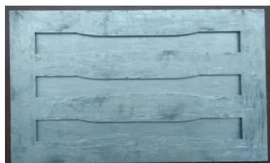
Gambar 3.3 Cetakan ( Molding ) sesuai dimensi standart ASTM D638-01
