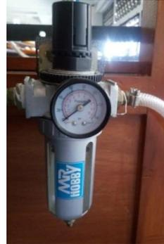
Gambar 3.7 Filter dan regulator udara (*watertrap*)
