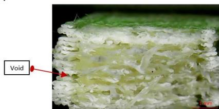
Gambar 14 foto area patahan *extrusion width* 0.3 patahan *extrusion width* 0.4
