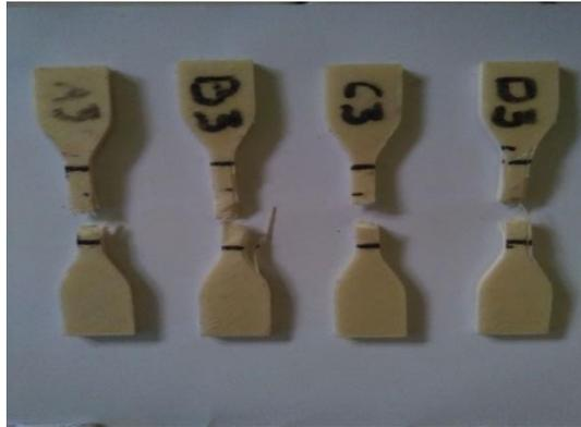
Gambar 5. Spesimen hasil uji tarik
