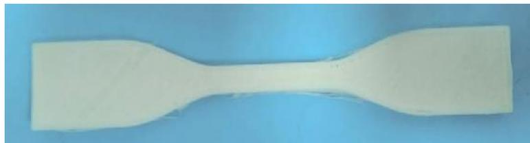
Gambar 3.17. Pencetakan Spesimen dengan *extrusion width* 0.4
