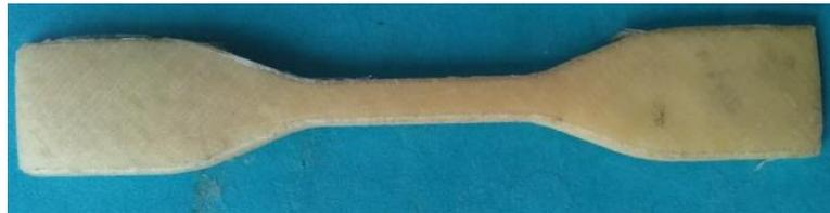
Gambar 3.16. Pencetakan Spesimen dengan *extrusion width* 0.3
