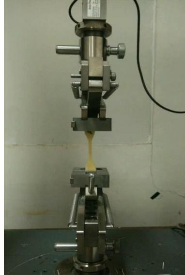
Gambar 3.26. Proses pengujian tarik
